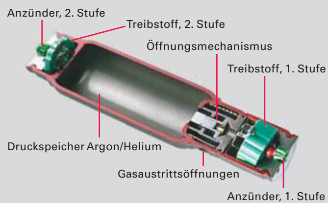
Hybridgasgenerator (zweistufig) für Beifahrerairbag. Quelle: Autoliv
