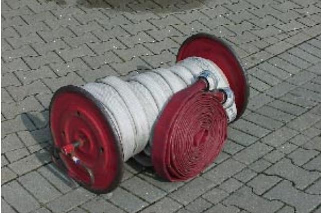
Der Druckschlauch ist ein Schlauch der sich in ungefülltem Zustand flach falten und rollen läßt. Er dient zur Förderung von Löschmitteln wie Wasser, Wasser mit Löschmittelzusätzen, Schaum, Pulver und in Sonderfällen auch anderer Medien.
